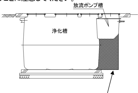
埋め戻しの際、放流ポンプ槽の底部および浄化槽とポンプ槽の隙間に十分土を入れてください。
