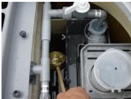
ひしゃくを用いた採水
