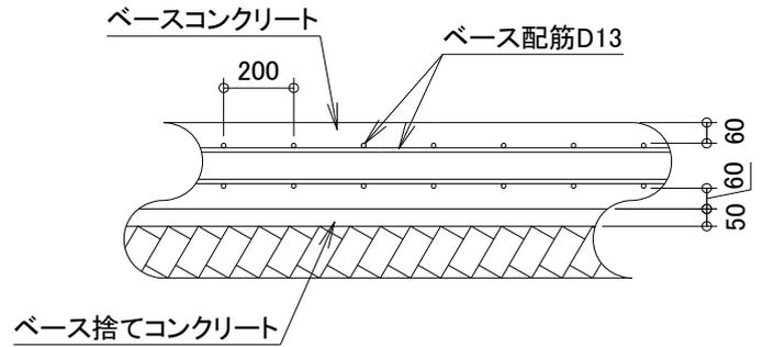
図 5 参考図(配筋例)
