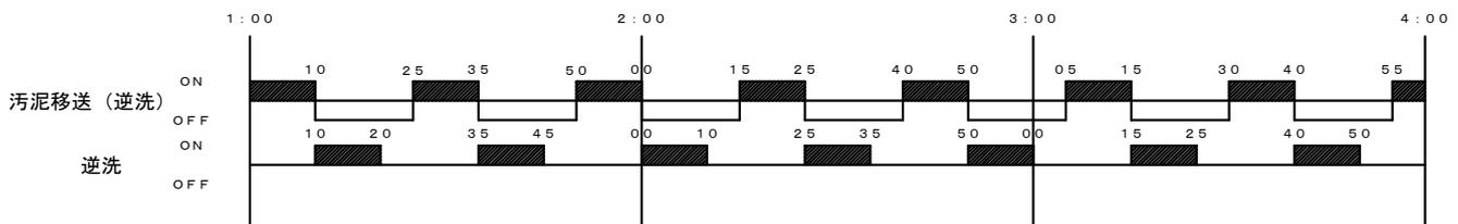
図5 逆洗工程タイムチャート（標準設定）
